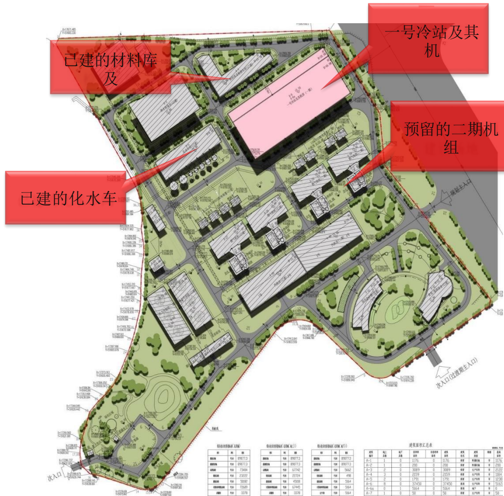
图1-1 一号冷站及其机房项目范围与能源站用地红线关系示意图
